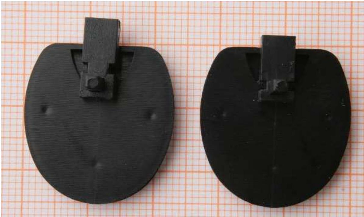
Kulissenführung 101: links mit Schacht 103, rechts mit kurzem Schacht 110. Die Gehäusehöhe der Kulisse beträgt ohne Stift etwa 2,5mm.
